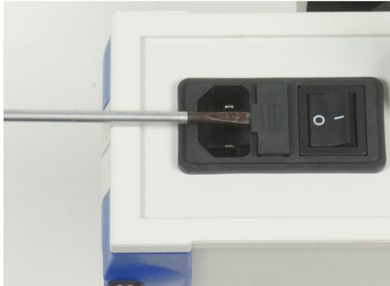
Fig. 1 Sicherungswechsel.
