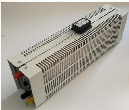
**Abb. 4a) Drahtpotentiometer**
