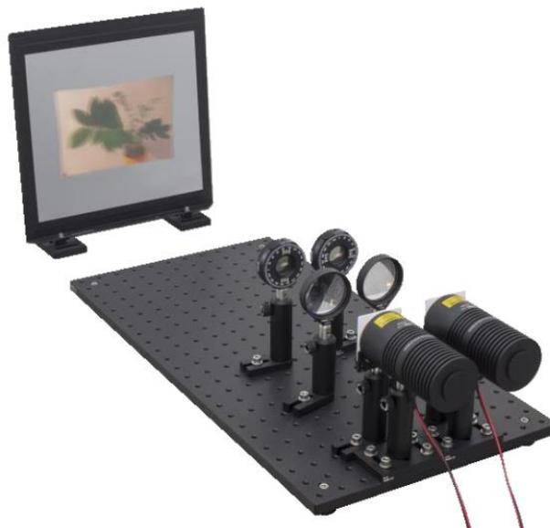
**Abbildung 1: Aufbau zur 3D-Projektion mit linearer Polarisation**
