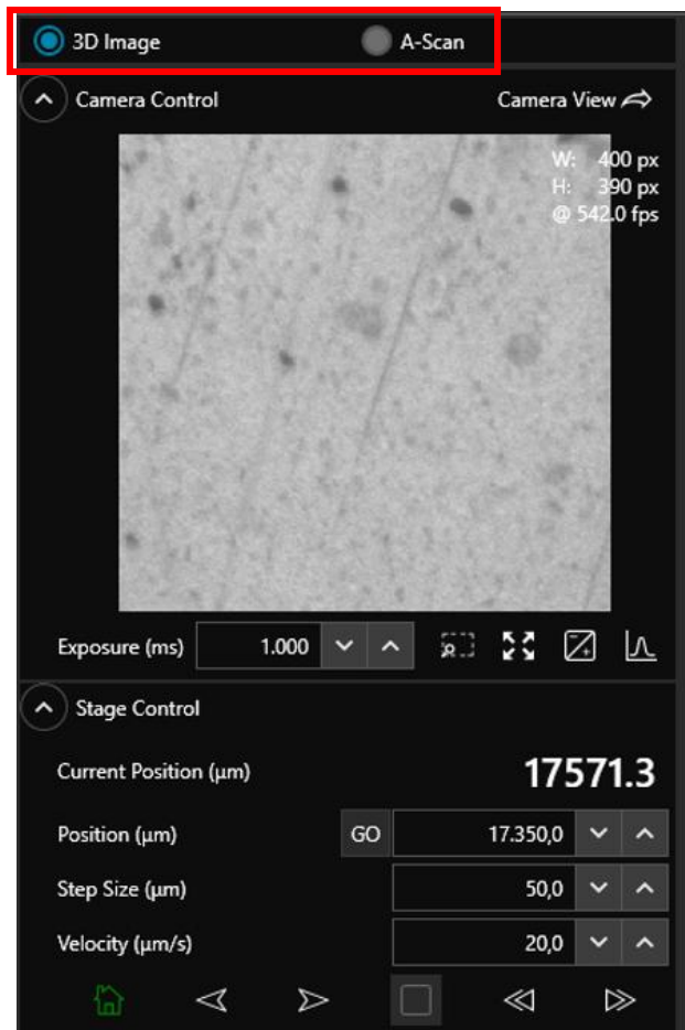
Abbildung 7: Grafische Oberfläche EDU-OCT; im Bildfenster ist die Oberfläche einer Probe zu sehen.
