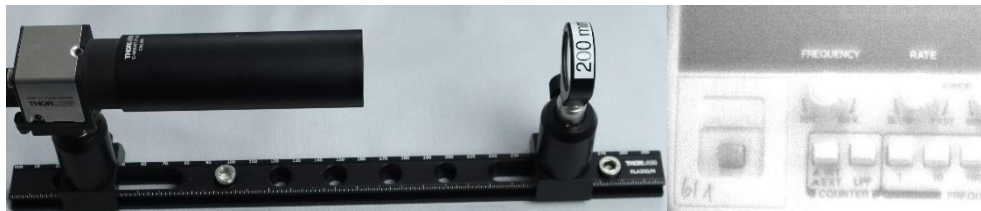
Abbildung 2: links: Kamera und Linse auf einer Schiene; rechts: scharfes Bild eines ca. 5 m entfernten Oszilloskops
